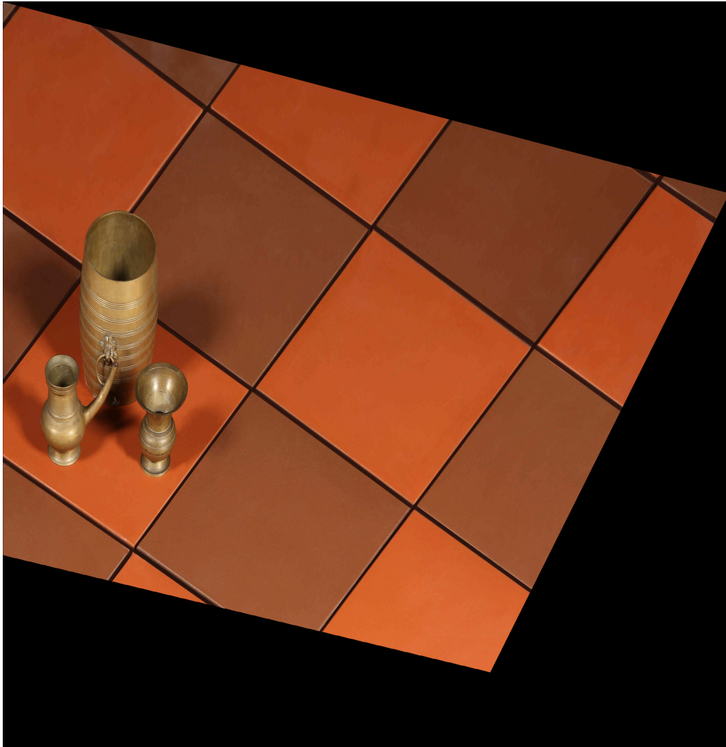
Obr. 3: Obrázok dlaždíc po metrickej rektifikácii – všimnime si, že dlaždica je už štvorcová, ale natočená. To je prejav faktu, že nájdená transformácia je určená až na podobnosť. Tiež si môžeme všimnúť, že hrany nádob sa transformovali z elips na kruhy. Samotné nádoby sú samozrejme oproti skutočnosti deformované, pretože hľadaná transformácia je transformácia roviny, čiže sa ticho predpokladá, že všetky objekty na obrázku ležia v jednej rovine.
